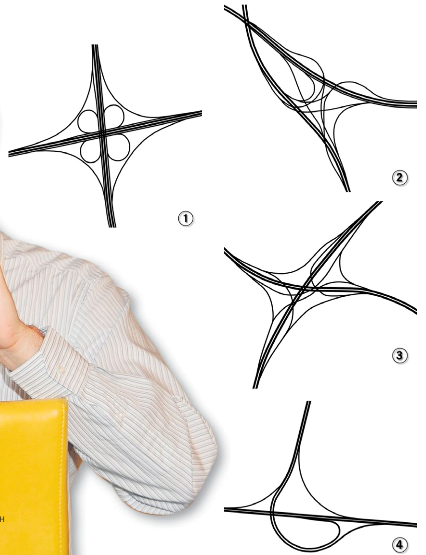
Hendrik Bugdoll entwickelt den „App“ für Autobahnkreuze. Von ihnen gibt es viele Formen, darunter 1. Malteserkreuz (Wetzlarer Kreuz) 2. Kleeblatt (Hermsdorfer Kreuz) 3. Trompete (Dreieck Halle-Süd) und 4. Spaghettiknoten (Kreuz Kaiserberg). FOTO: DEUTSCH
